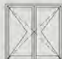
Porta | Door | Porte Batente int|ext 1|2 folhas french door in|out 1 |2 leaves à la française int|ext 1|2 vantaux
